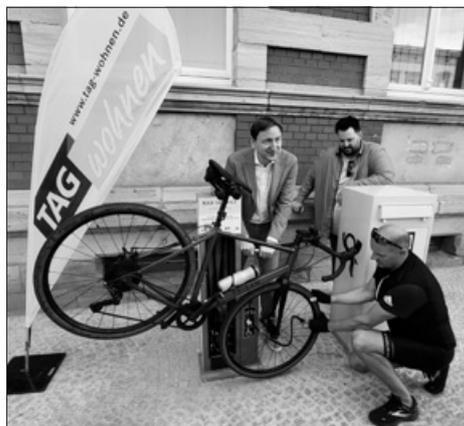
so bequemer zu reparieren. Die Werkzeuge hängen an Stahlseilen mit PVC-Ummantelung, deren Länge die Möglichkeit geben, alle Fahrrad-Komponenten zu erreichen. Die Station ist mit einer Luftpumpe mit Manometer und Adaptern für alle gängigen Ventilvarianten ausgestattet. Darüber hinaus sind u.a. ein T25 Torx-Schraubendreher, ein verstellbarer Einmaulschlüssel, Doppelmaulschlüssel 8x10 mm/13x15 mm, ein Inbusschlüssel-Set und Reifenheber vorhanden.
