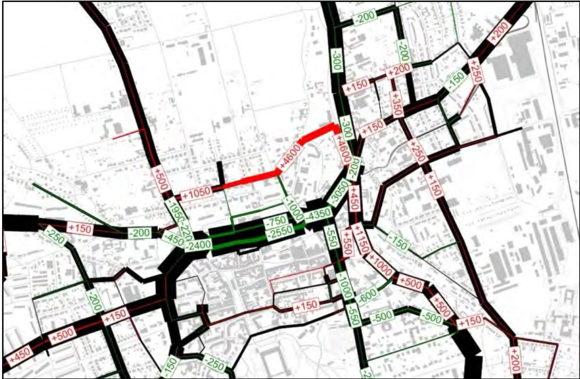
Abb. 4: Veränderung der Verkehrsbelegung - Wiederherstellung zweistreifige Befahrbarkeit des Heutalsweges
